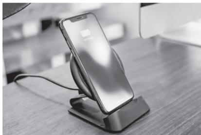
Аксессуар Charge Stream Desk Stand, в свою очередь, предназначен для стационарного использования на рабочем столе. Смартфон располагается на подставке под удобным для просмотра углом. Поддерживается стандарт Qi; мощность достигает 10 Вт. Изделие также стоит около 70 долларов.
