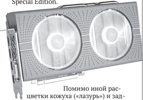
Помимо иной расцветки кожуха («лазурь») и задней усилительной пластины («серебро»), особых различий между вышеупомянутыми версиями не наблюдается. Частота ядра новинки Nitro+ RX 580 Special Edition пока неизвестна, но зато микросхемы GDDR5 разогнаны с 2000 (8000) МГц до более высокой частоты — 2100 (8400) МГц.
