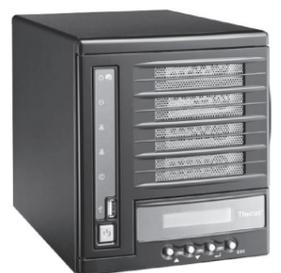
Основные технические характеристики Thecus N4520: четыре отсека для установки 3,5-дюймовых SATA-винчестеров, LCM-дисплей с четырьмя кнопками управления, 2 Гбайт оперативной памяти DDR3, поддержка RAID 0/1/5/6/10 и JBOD, гигабитный Ethernet-контроллер, два порта USB 2.0, один порт USB 3.0, разъем RJ-45, выходы HDMI и S/PDIF, габаритные размеры составляют 226x165x192 мм.
