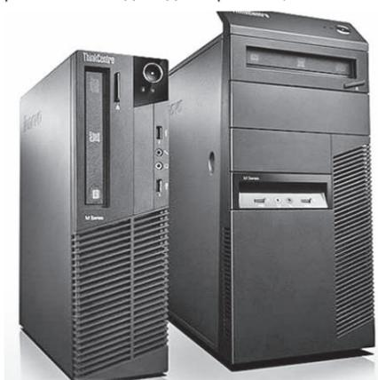
можно установка дискретного графического контроллера. Поддерживается одновременное подключение до четырех дисплеев. Десктоп располагает 6-канальным (5.1) звуковым кодеком, сетевым контроллером Gigabit Ethernet, кардридером «25 в 1», рекордером DVD, а также восемью портами USB 2.0.
