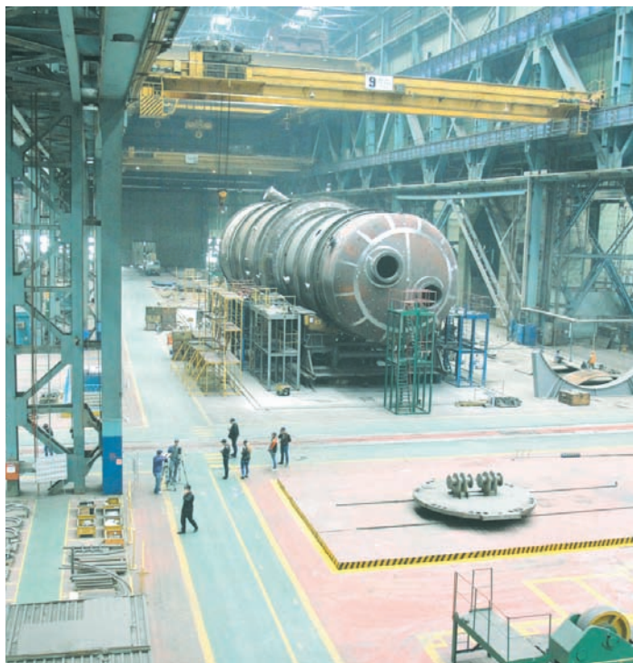
Собранная на Атоммаше 52-метровая вакуумная колонна диаметром 11,5 м, которая будет изготовлена и испытана здесь и доставлена водным транспортом по северному морскому пути через Карские ворота для омского МПЗ
