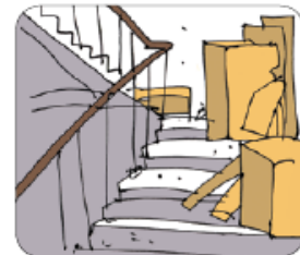
Складирование вещей на лестничных клетках, поэтажных коридорах, под лестницей
